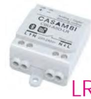
Controlador Casambi para equipos regulables mediante DALI o señal 0-10V. Tiene una salida para alimentar un relé externo de 230Vca. Se puede configurar como entrada de pulsador. Incluye alimentación DALI para uso autónomo de 6mA (máximo 3 drivers). Soporta redes Long range
