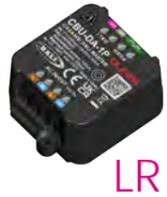
Convertidor Casambi para control de equipos DALI. Integra una fuente de alimentación del bus DALI con una corriente garantizada de 100mA. Se pueden controlar hasta 50 drivers LED con un único dispositivo. Existen multitud de perfiles Casambi disponibles (DT6, DT8, TW, TGBW, XY, etc). Entrada de pulsador. Soporta redes Long range
