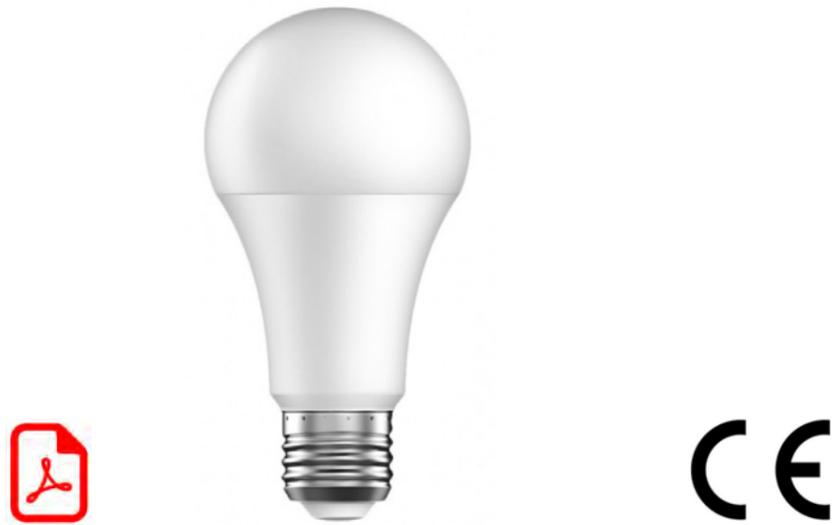
E27 Smart White es una bombilla con regulación Casambi. Temperatura de color regulable entre 2200-6500K. Con factor de potencia de 0,9 y protección IP50. Debe instalarse permitiendo la libre circulación del aire. Temperatura ambiente máxima 25°C
