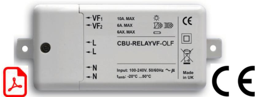
El CBU-RELAYVF-OLF es un relé Casambi con contacto libre de potencial, normalmente abierto. Se alimenta a 100-240Vca. Puede conmutar hasta 10A en función del tipo de carga
