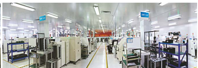
Sala limpia de soldadura automática
