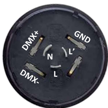
VISTA INFERIOR Nota: La entrada L y la salida L están puenteadas internamente.
