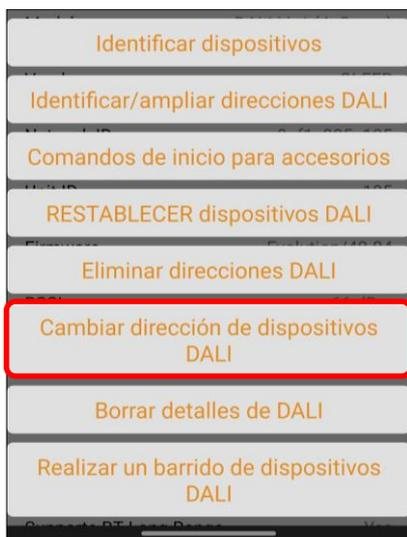
Esta acción hará que el CBU-DA-1P redireccione todos los equipos que tiene conectados en el bus DALI.
