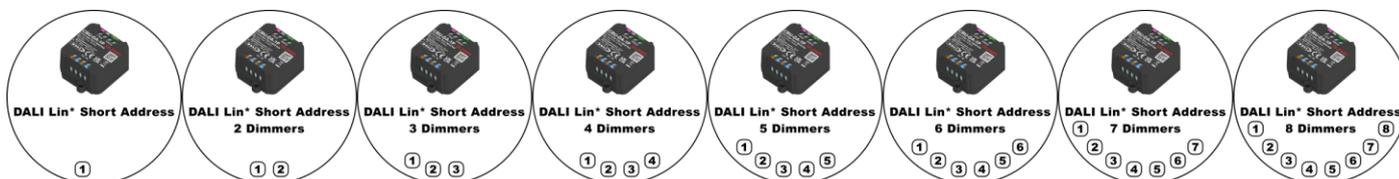
Estos perfiles controlan los equipos a través de direcciones DALI (short address), el primero tiene un slider que regula A0, el segundo perfil tiene dos sliders que regulan A0 y A1, y así hasta el perfil "DALI Lin\* 8xDIM SA" que tiene 8 sliders que controlan 8 direcciones DALI, desde A0 hasta A7.
