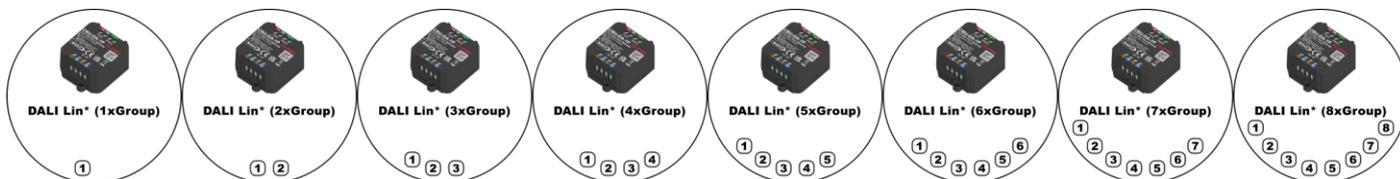
Al igual que con los perfiles del tipo "DALI Lin\*\_xDIM SA", cada uno de estos perfiles tiene un número concreto de sliders que controlan grupos DALI. El primer perfil tiene un slider que controla G0, el segundo perfil tiene dos sliders que controlan G0 y G1 y así hasta el perfil "DALI Lin\* (8xGroup)" que tiene 8 sliders y controla 8 grupos desde G0, hasta G7.
