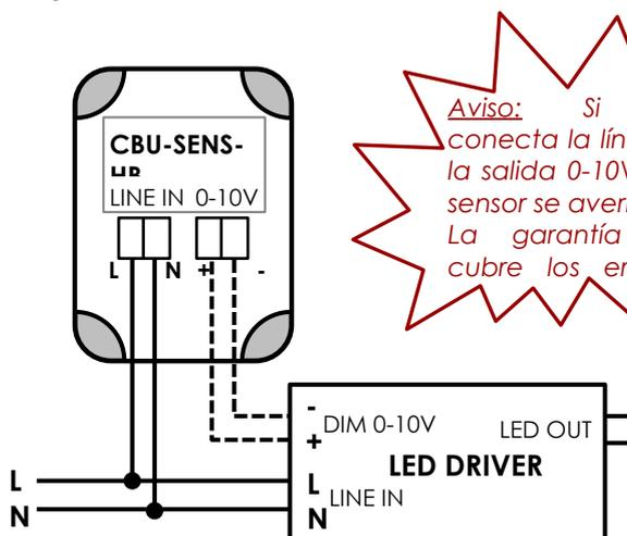
**Aviso:** Si se conecta la línea a la salida 0-10V, el sensor se averiará. La garantía no cubre los errores
