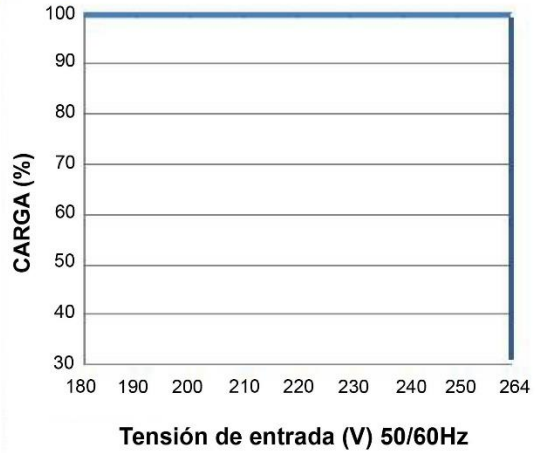
Carga vs Tensión de entrada
