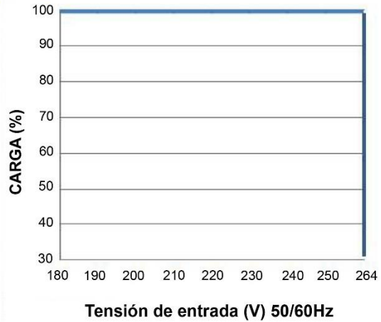
Carga vs Tensión de entrada
