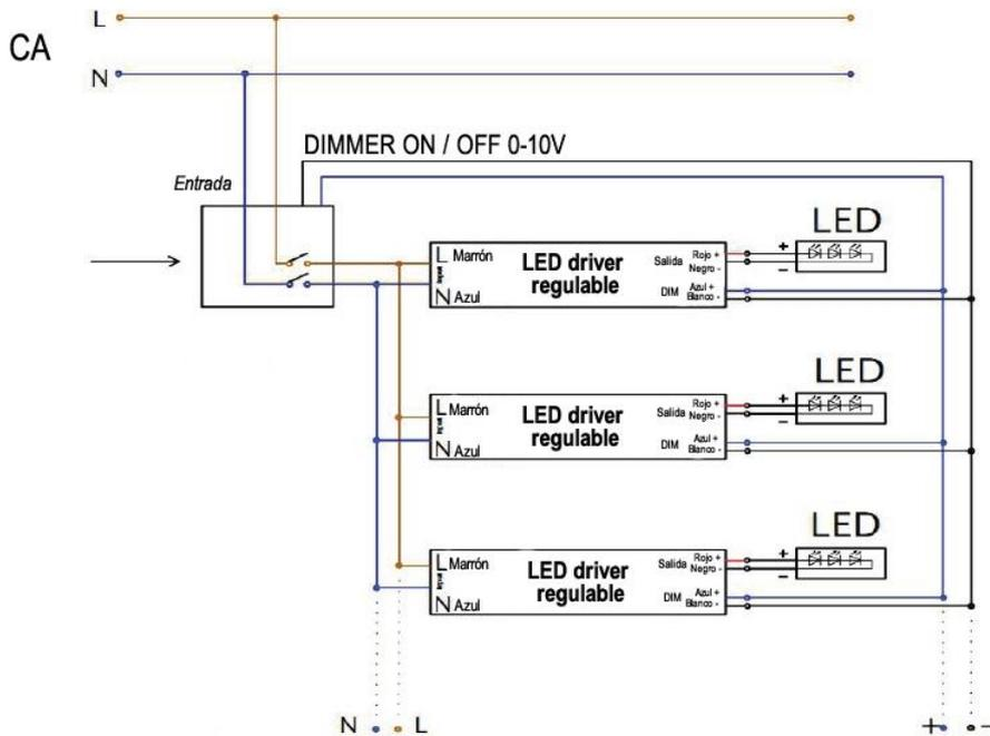
▪ **Regulación de la corriente de salida, dimado:**
