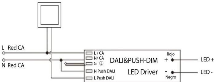
Esquema de conexión : Interruptor ON/OFF + PULSADOR
