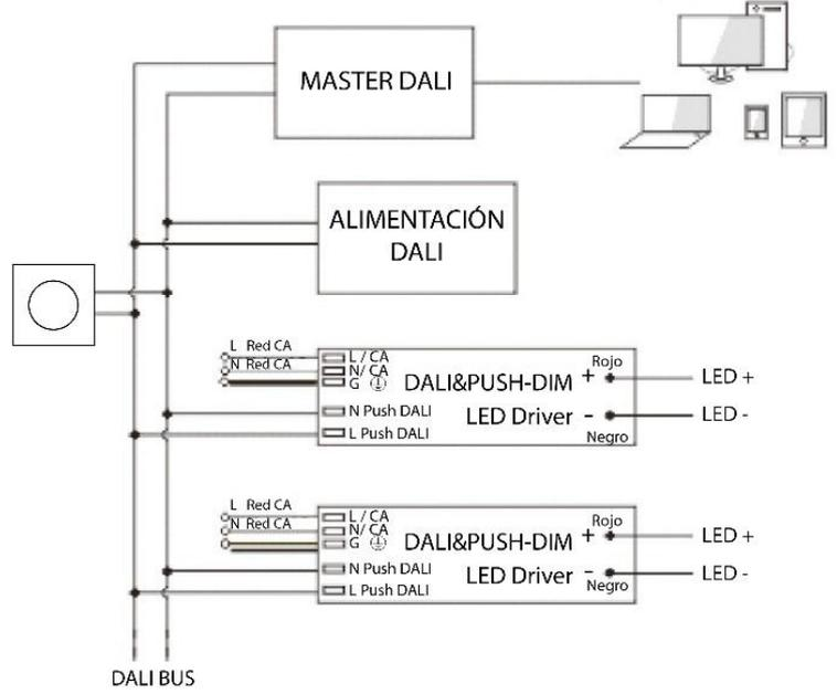
Esquema de conexión: Sistema DALI
