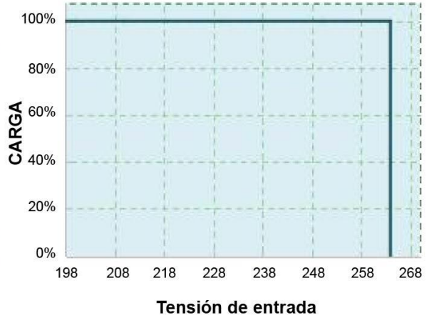
Carga vs Tensión de entrada
