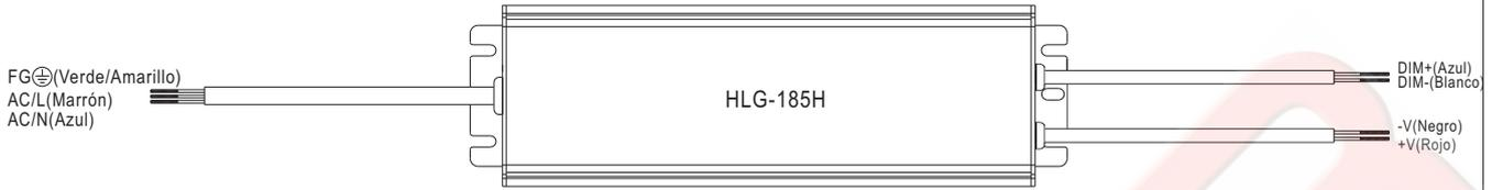
※ Función de regulación de la corriente de salida (dimming) 3 en 1; la corriente de salida puede ajustarse mediante señales 1~10Vcc, 10V PWM o resistencia conectadas a los terminales DIM+ y DIM-.
