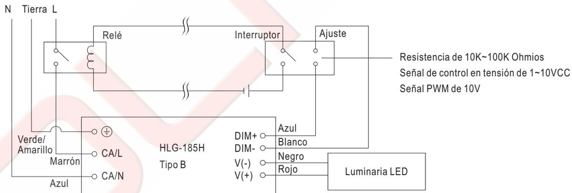
Utilizando un interruptor y un relé puede apagar completamente la luminaria.
