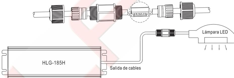
※El CJ04 (cable joiner) se puede adquirir de forma independiente para diversos montajes.
