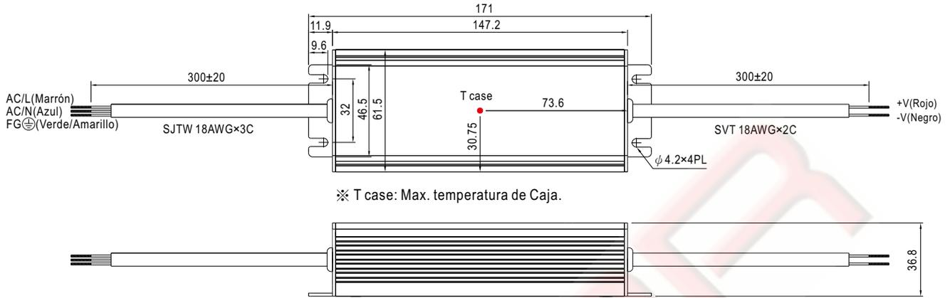
※ IP67. Función de regulación (dimado) a través de temporizador; para mayor información contacte con Meanwell.
