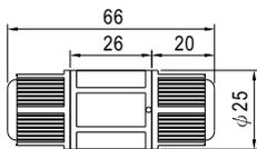
CJ04-1 compatible con 14AWG~16AWG
