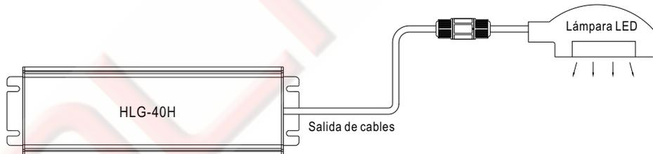
※El CJ04 (cable joiner) se puede adquirir de forma independiente para diversos montajes.
