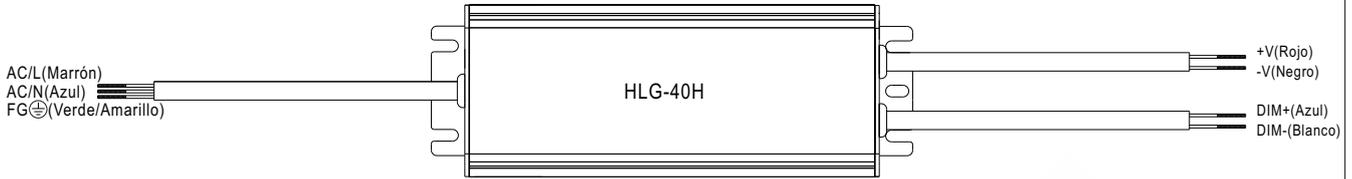
※ Función de regulación de la corriente de salida (dimming) 3 en 1; la corriente de salida puede ajustarse mediante señales 1~10Vcc, 10V PWM o resistencia conectadas a los terminales DIM+ y DIM-.
