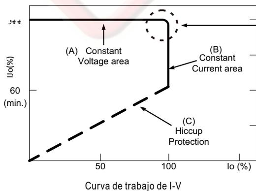
En modo de trabajo de corriente constante la tensión dependerá del número de LEDs y número de LEDs en serie, así como la temperatura ambiente y Vf de los LEDs.
