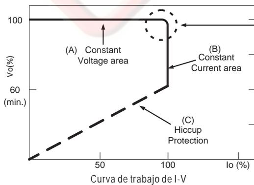
En modo de trabajo corriente constante la tensión dependerá del número de LEDs y número de LEDs en serie, así como la temperatura ambiente y Vf de los LEDs.
