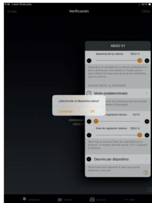
Figura 9. Desvincular NR40 del dispositivo. Para conectar la luminaria a otro dispositivo, es necesario desvincular.
