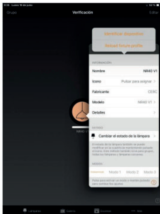
Figura 8. Modelo/Reload fixture se actualizará el firmware de la luminaria
