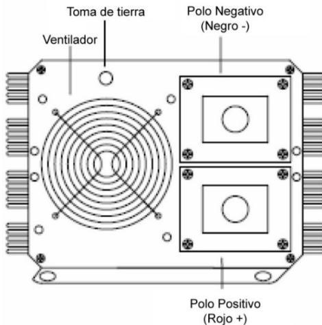
**2.2.1. Ventilador:**..... El ventilador desaloja el calor interno del inversor durante su funcionamiento normal.
