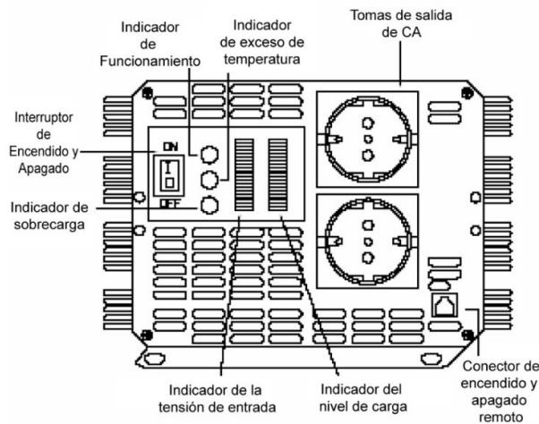
**2.1.1. Interruptor ON/OFF .....** El interruptor ON/OFF enciende y apaga el inversor. No es necesario desconectar la alimentación del inversor cuando no se está utilizando. No obstante, el equipo siempre tiene un consumo incluso estando en la posición OFF, por lo que si no lo van a utilizar en un tiempo recomendamos desconectarlo de las baterías para evitar la descarga de las mismas. Igualmente deberán recargar las baterías periódicamente para mantenerlas en buen estado
