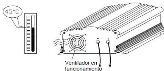
Precaución: no invierta las conexiones de entrada. Utilice el cable rojo para conectar el polo positivo de la batería con la toma + del inversor y el cable negro para conectar la toma negativa de la batería con el terminal negativo de entrada.
