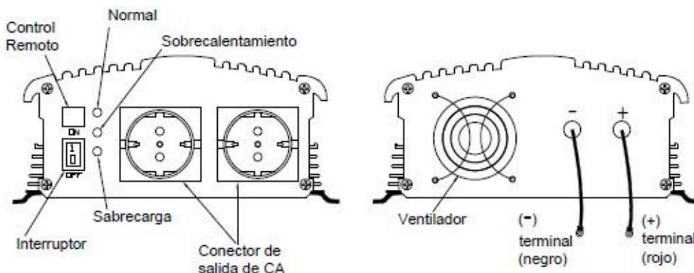
Cuando conecte una carga, asegúrese de encender primero el inversor y luego encienda las cargas conectadas.
