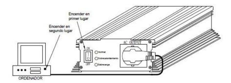
No utilizar el inversor más allá de su máxima potencia de salida. Cuando lo conecte a alguna carga, asegúrese que el pico de arranque no excede la máxima potencia de salida del inversor.
