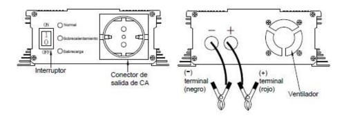
Cuando conecte una carga, asegúrese de encender primero el inversor y luego encienda las cargas conectadas.
