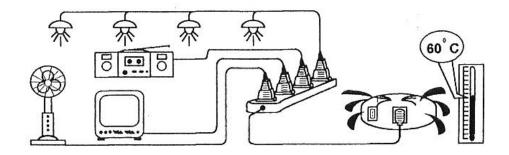
Cuando se produce una situación de cortocircuito en la salida, sobrecarga o sobrecalentamiento, los leds parpadearán de modo que el usuario pueda conocer el problema y resolverlo. Señales de aviso:
