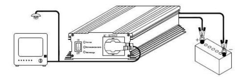
Precaución: no invierta las conexiones de entrada. Utilice el cable rojo para conectar el polo positivo de la batería con la toma + del inversor y el cable negro para conectar la toma negativa de la batería con el terminal negativo de entrada.
