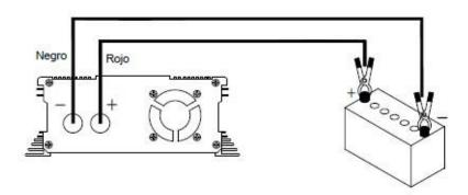
Si los vatios de las cargas conectados supera la capacidad máxima del inversor o si durante un uso prolongado la tempera del inversor alcanza 60°C el inversor reducirá su salida de CA mediante el circuito de protección.
