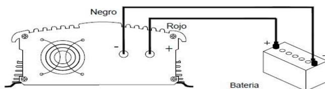
Si los vatios de las cargas conectadas supera la capacidad máxima del inversor o si durante un uso prolongado la temperatura del inversor alcanza 60°C el inversor reducirá su salida de CA mediante el circuito de protección.
