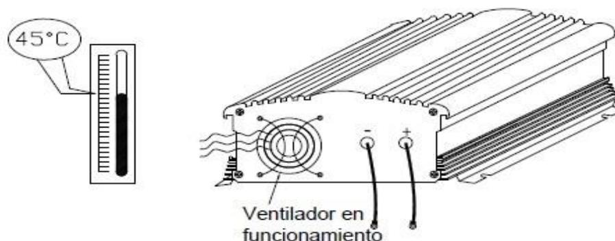
Precaución: no invierta las conexiones de entrada. Utilice el cable rojo para conectar el polo positivo de la batería con la toma + del inversor y el cable negro para conectar la toma negativa de la batería con el terminal negativo de entrada.
