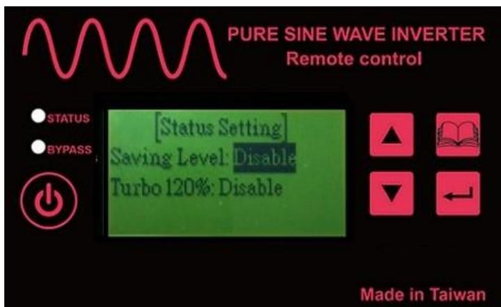
Figura 15: Pantalla de ajuste de funciones de Status
