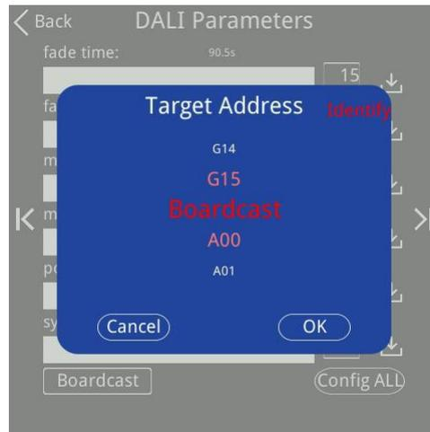
Deslice la rueda de desplazamiento para seleccionar la dirección del dispositivo correspondiente y pulse en **OK** para que surta efecto.
