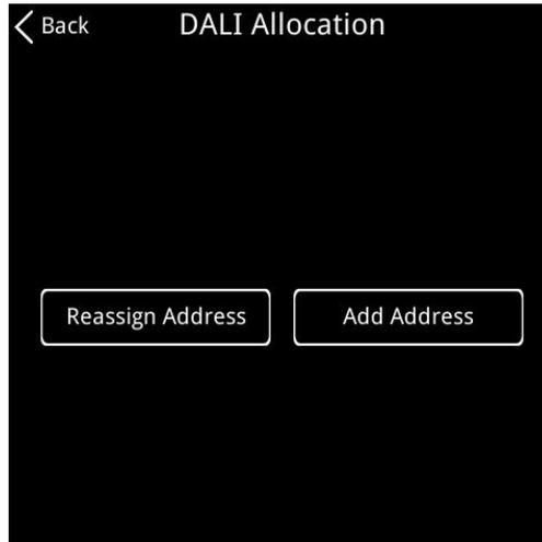
**Reasignar direcciones:** Se reasignarán direcciones DALI a todos los dispositivos del bus.
