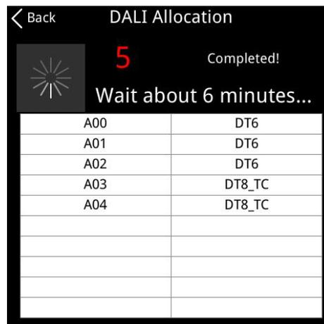
Si la asignación de direcciones se completa o se agota el tiempo máximo del proceso, se mostrará automáticamente la pantalla de resultados de espera, saltará automáticamente a la interfaz de resultados de la asignación.
