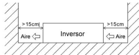
No coloque nada encima del equipo esto aumentará la temperatura interna del mismo reduciendo la vida del equipo drásticamente.
