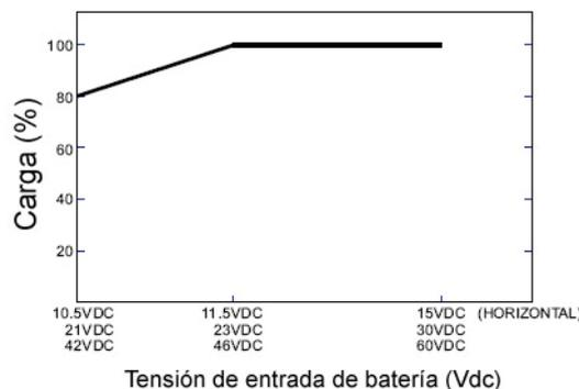
Figura 6.3: Deriva según la tensión de entrada
