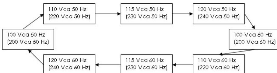
Figura 4.2 - Diagrama de tensión y frecuencia de salida
