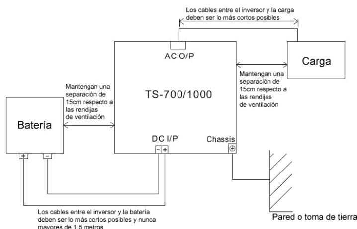
La conexión de los cables de entrada (DC I/P) debe realizarse de la siguiente manera:
