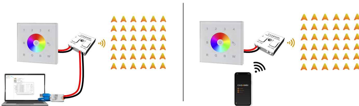
- Esquema del proceso de direccionamiento/asignar grupos desde un programador DALI Vs. Casambi -
