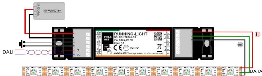
Figura 2: Diagrama de conexión para cargas LED digitales
