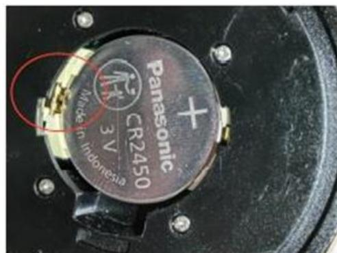
Asegúrese que el terminal positivo queda por encima de la batería y el negativo por debajo.
